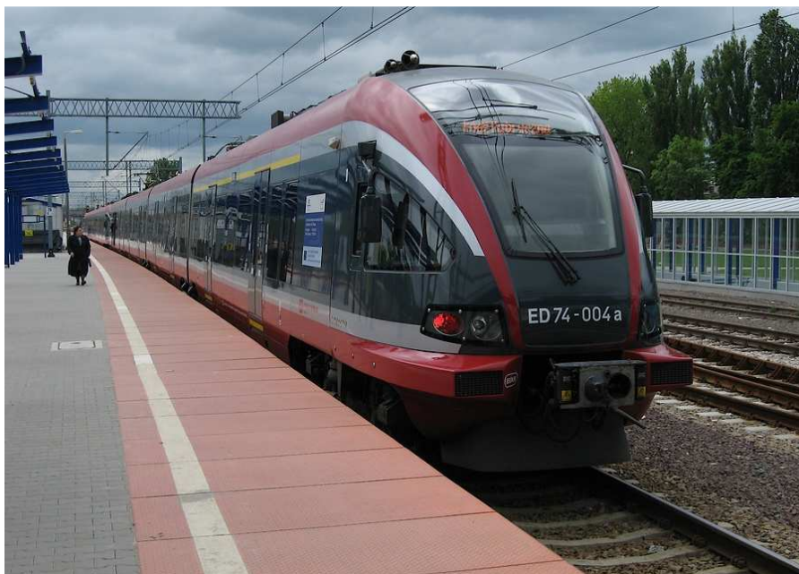
Rys. 7.4. Przykład pojazdu kolejowego z obniżoną podłogą do znormalizowanej wysokości peronu (550 mm nad główką szyny). Dodatkowym elementem elektrycznego zespołu trakcyjnego są wysuwane schodki w przypadku znacznej różnicy wysokości do peronu. Źródło: materiały własne TRAKO.
