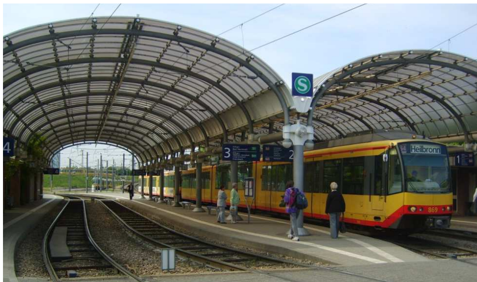
Rys. 9.6. Przykład tramwaju dwusystemowego w miejscu połączenia z linią kolejową (Karlsruhe, Niemcy). Źródło: materiały własne TRAKO.
