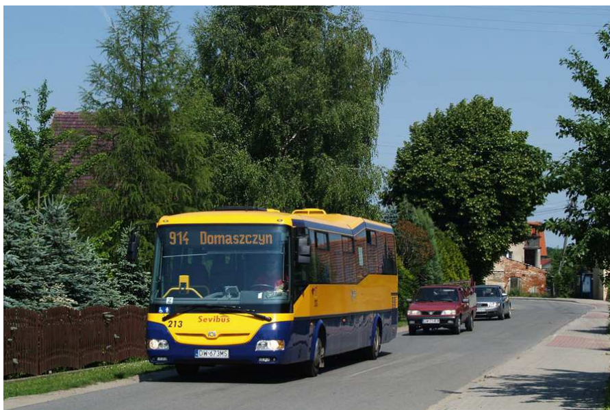
Rys. 7.3. Przykład autobusu z częściowo obniżoną podłogą przystosowanego do przewozu osób niepełnosprawnych w komunikacji regionalnej. Źródło: materiały własne TRAKO.
