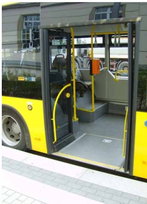
Rys. 7.6. Przerwa między peronem przystankowym a autobusem. Źródło: materiały własne TRAKO.
